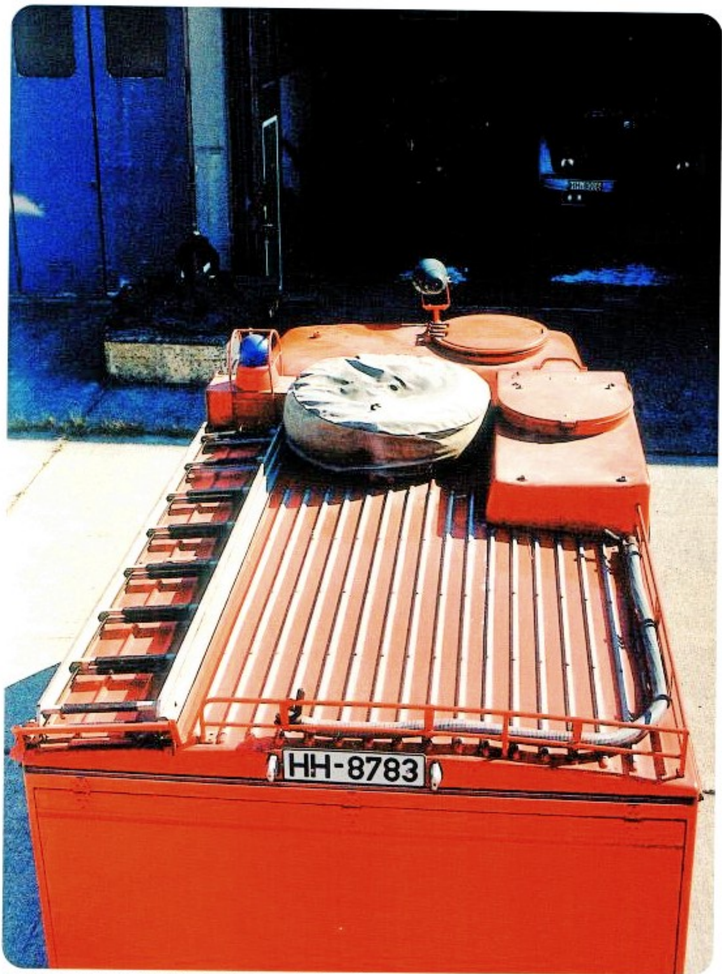
Dachbeladung eines TLF 8 als FSW mit Magirus-Steckleiter, Reserverad und Abgasschlauch 2,50 m (35)
